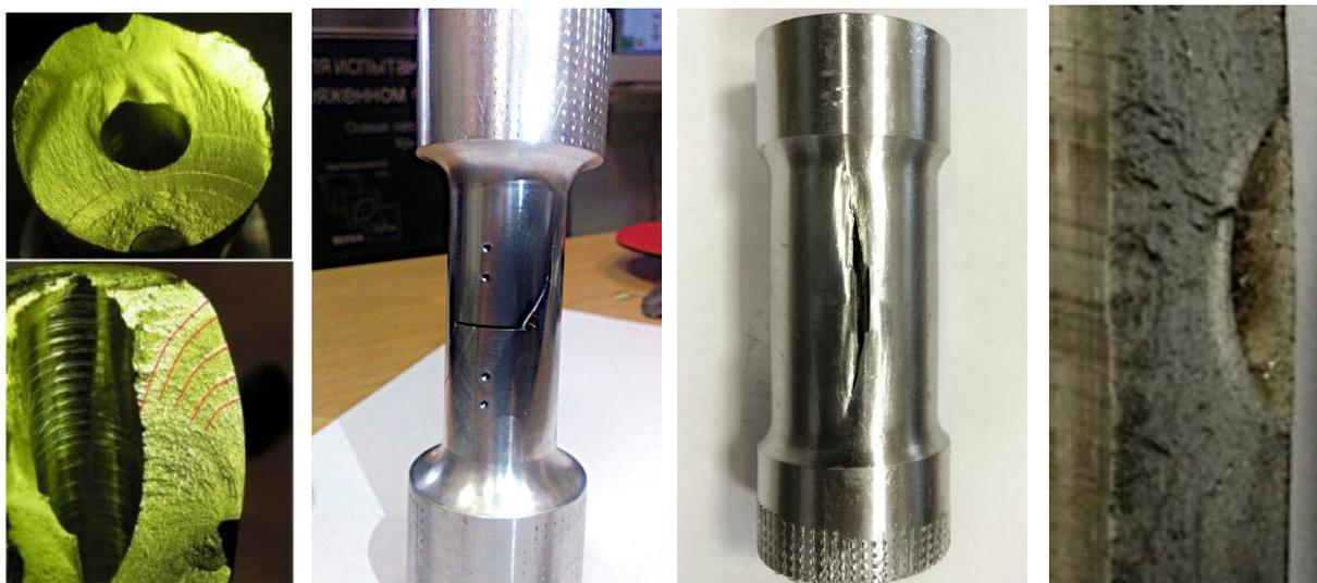
**Рис. 3.** Типичные положения поперечного и продольного фронта развивающейся трещины
