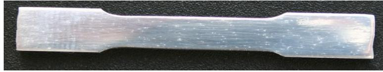
Рисунок 2.2 – Геометрия образца из монокристалла алюминия (41x3,8x1,8 мм)
