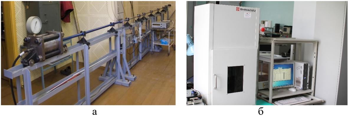
Рисунок 4.1 – Испытательный комплекс в лаборатории Физических основ прочности ИМСС УрО РАН: а) Разрезной стержень Гопкинсона-Кольского, б) ультразвуковая испытательная машина Shimadzu USF-2000
