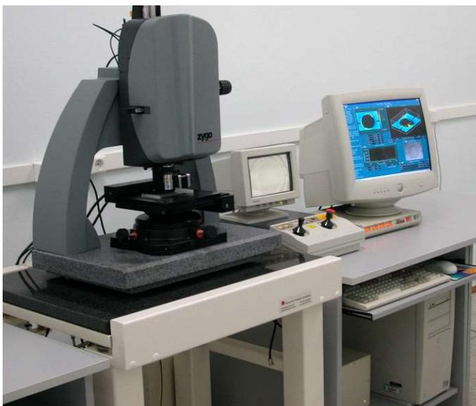
Рисунок 2.4 – Интерференционный микроскоп NewView 5010
