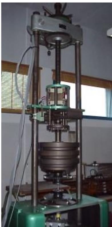
Рисунок 3.9 – Испытательная машина резонансного типа (Amsler Vibrophore)
