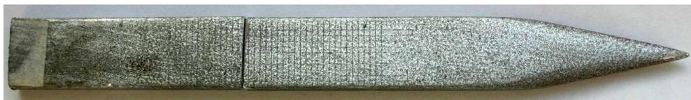
Рисунок 2.1 – Выращенный по методу Чохральского монокристалл алюминия (180x10x4 мм)
