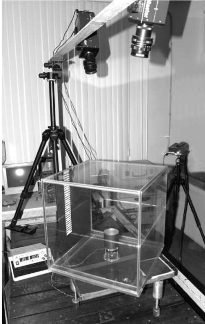
Рис. 6.1. Установка по исследованию закрученной струи воздуха.
