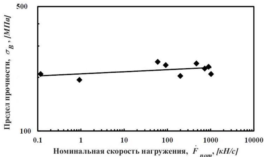
Рисунок 3.19 – Экспериментально полученная прочность на разрыв для гладких образцов из алюминиевого сплава Al6063-T5 в зависимости от номинальной скорости нагружения
