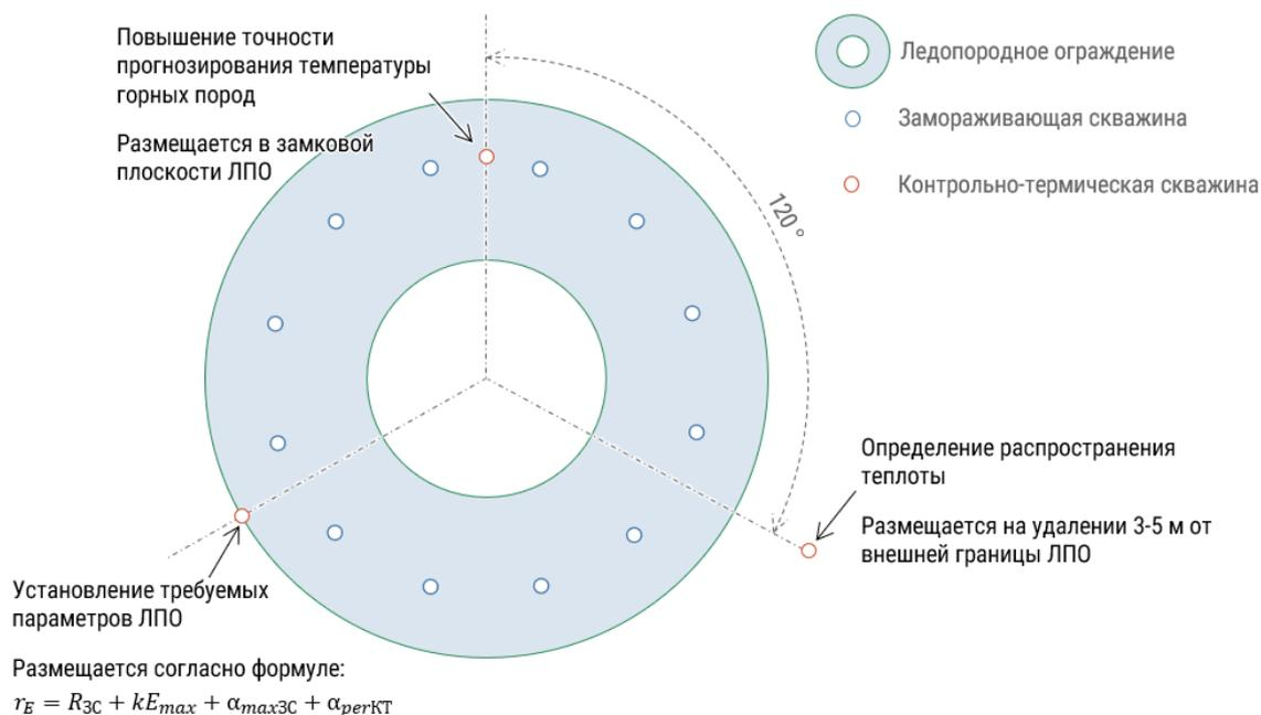
Рисунок 4.15 — Схематичное представление мест заложения контрольно-термических скважин
