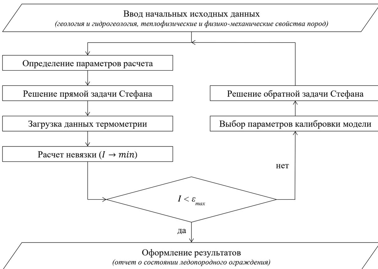
Рисунок 4 — Алгоритм работы автоматизированной системы термометрического контроля ледопородных ограждений
