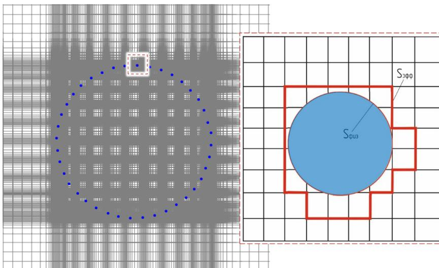
Рисунок 1 — Конечно-разностная сетка и эффективная площадь теплообмена
