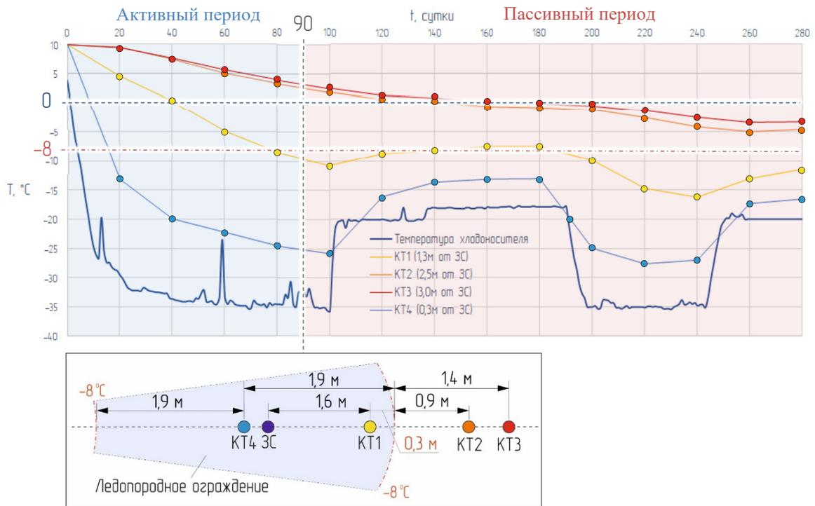
Рисунок 7 — Динамика температуры слоя глины в контрольно-термических скважинах и фактическое положение границ ледопородного ограждения на момент достижения им проектных параметров
