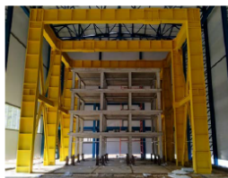
Железобетонная конструкция на стенде
