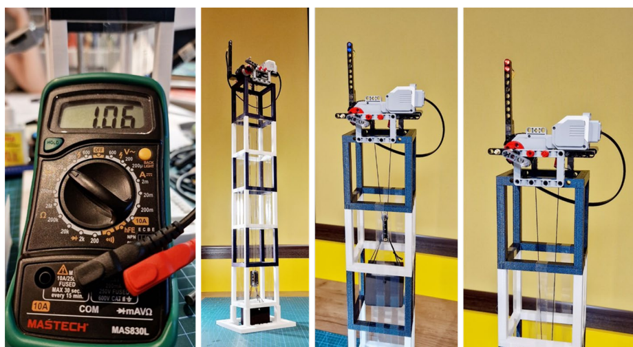
Рис. 4. Фотография прототипа ТАЭС и процесса измерения параметров тока
