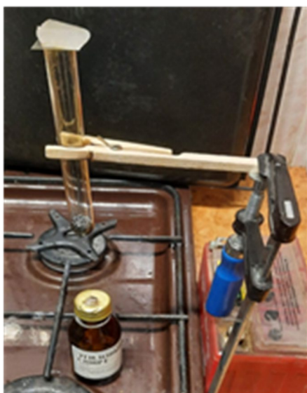
Рис. 2. Подогрев кристаллов йода
