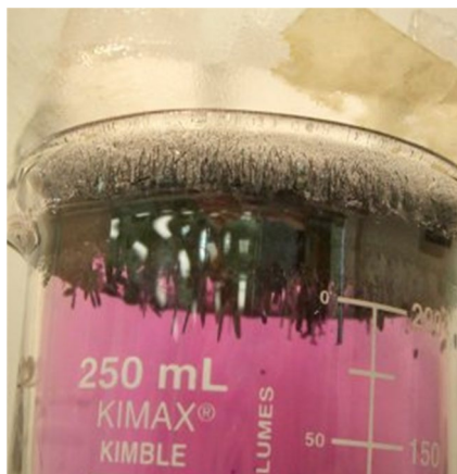
Рис. 2. Подогрев кристаллов йода
