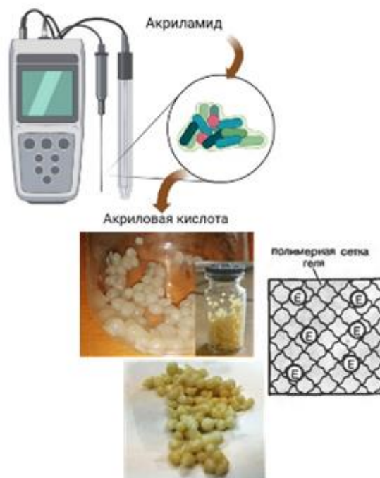
Рисунок 61 – Прототип кондуктометрического биосенсора на акриламид, биоселектирующим агентом которого являлись клетки Alcaligenes faecalis 2 с амидазной активностью, иммобилизованные в структуре гелей немодифицированного или модифицированного углеродными нанотрубками альгината бария, агарозы, а также выращенные в виде биопленок на терморасширенном графите.
