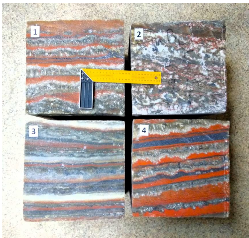
Рисунок 2.1 – Большие соляные образцы кубической формы
