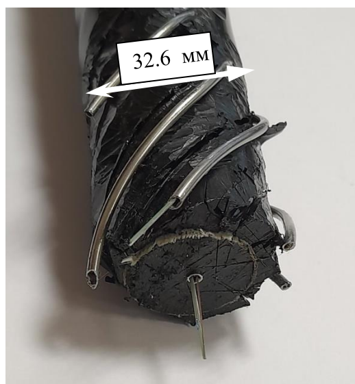
Рисунок 3.14 – Кабель, содержащий спиральное и прямое волокно
