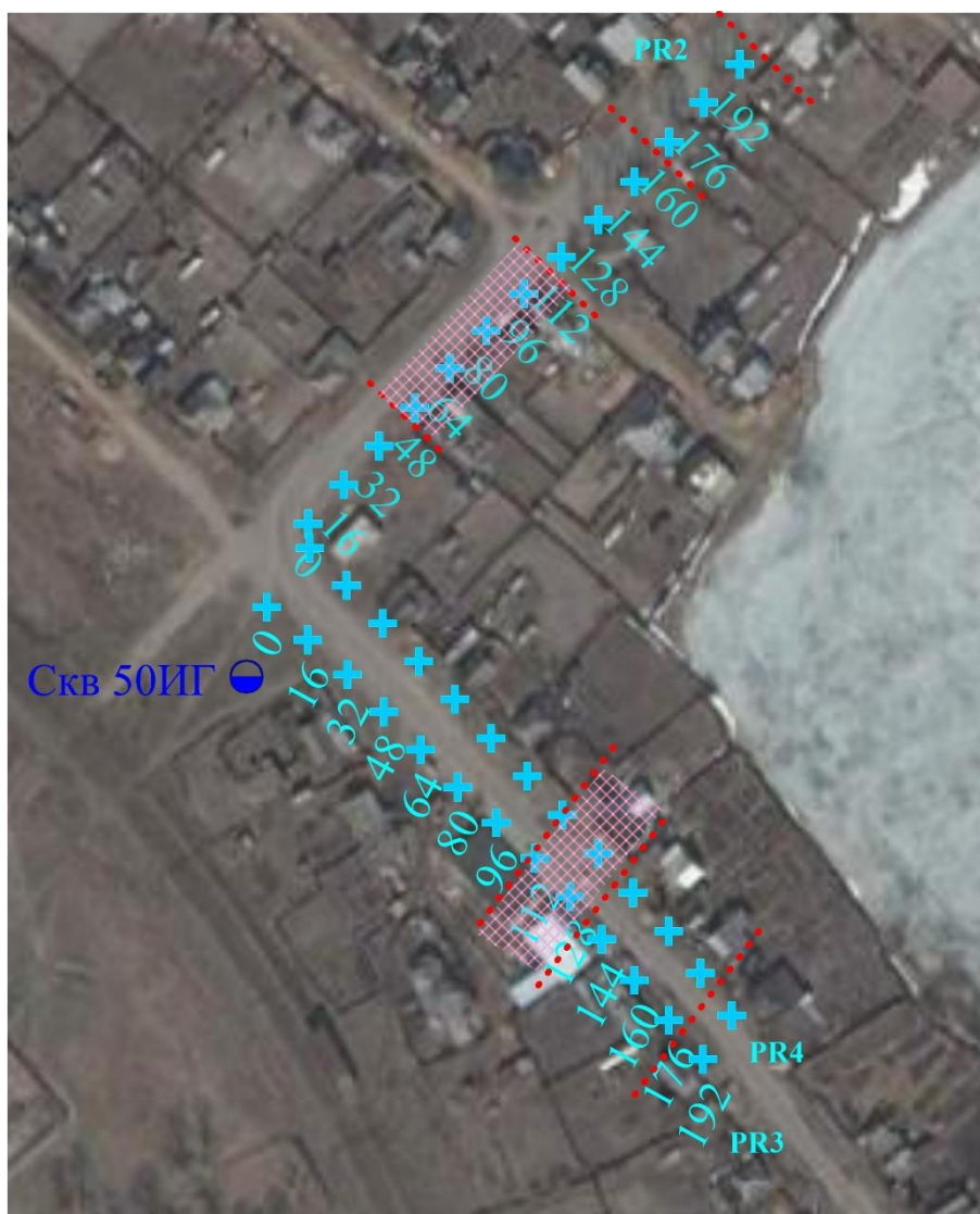
Рисунок 4.32 – Результаты интерпретации преломленных волн в методе ОВСП
