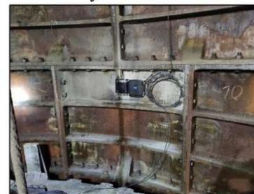
Контрольно-термическая скважина, оборудованная измерительным оптоволоконным кабелем. Оголовок открыт. Производится верификация показаний системы путем сопоставления с данными скважинного термометра.
