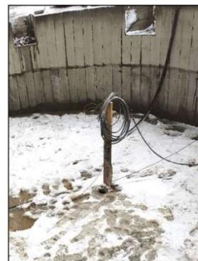
Гидронаблюдательная скважина в контуре проходки ствола, оборудованная измерительным оптоволоконным кабелем. Ликвидирована до начала проходки.
