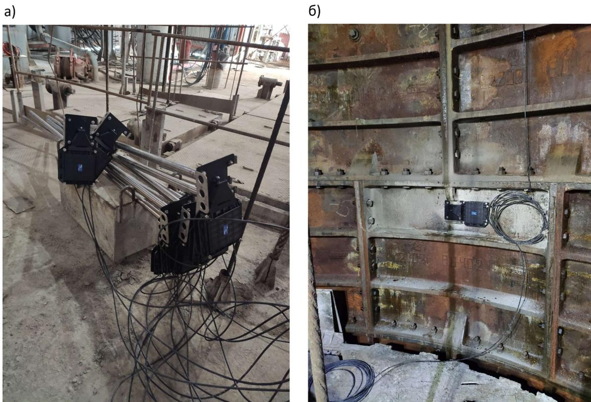
Рисунок 2.21 – «Гирлянда» скважинных оптоволоконных датчиков, подготовленная к установке (а) и датчик, установленный в крепи ствола (б)
