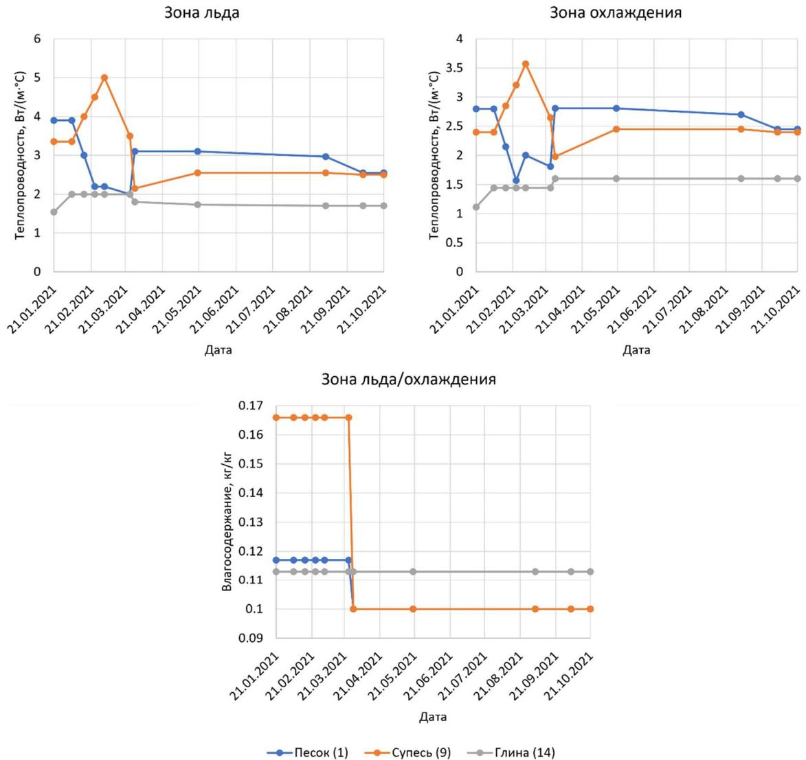
Рисунок 3.5 – Динамика эффективных теплофизических параметров пород при параметризации модели для условий скипового ствола Дарасинского рудника в разные моменты времени: а) теплопроводность в зоне льда, б) теплопроводность в зоне охлаждения, в) – влагосодержание
