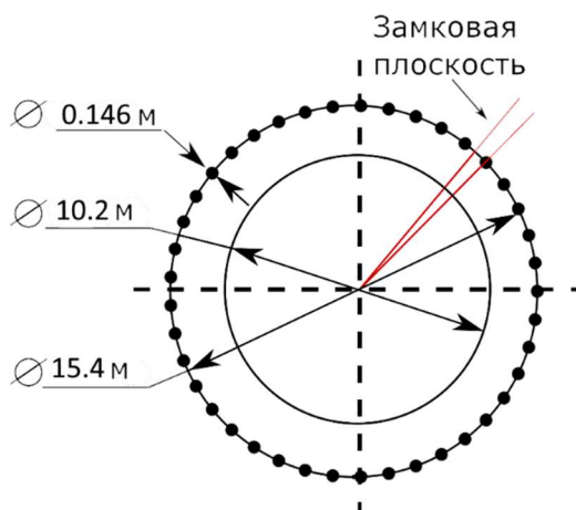
Рисунок 6.1 — Проектная схема расположения замораживающих скважин в горизонтальном сечении породного массива на участке Дарасинского месторождения (красными линиями ограничена рассматриваемая область)
