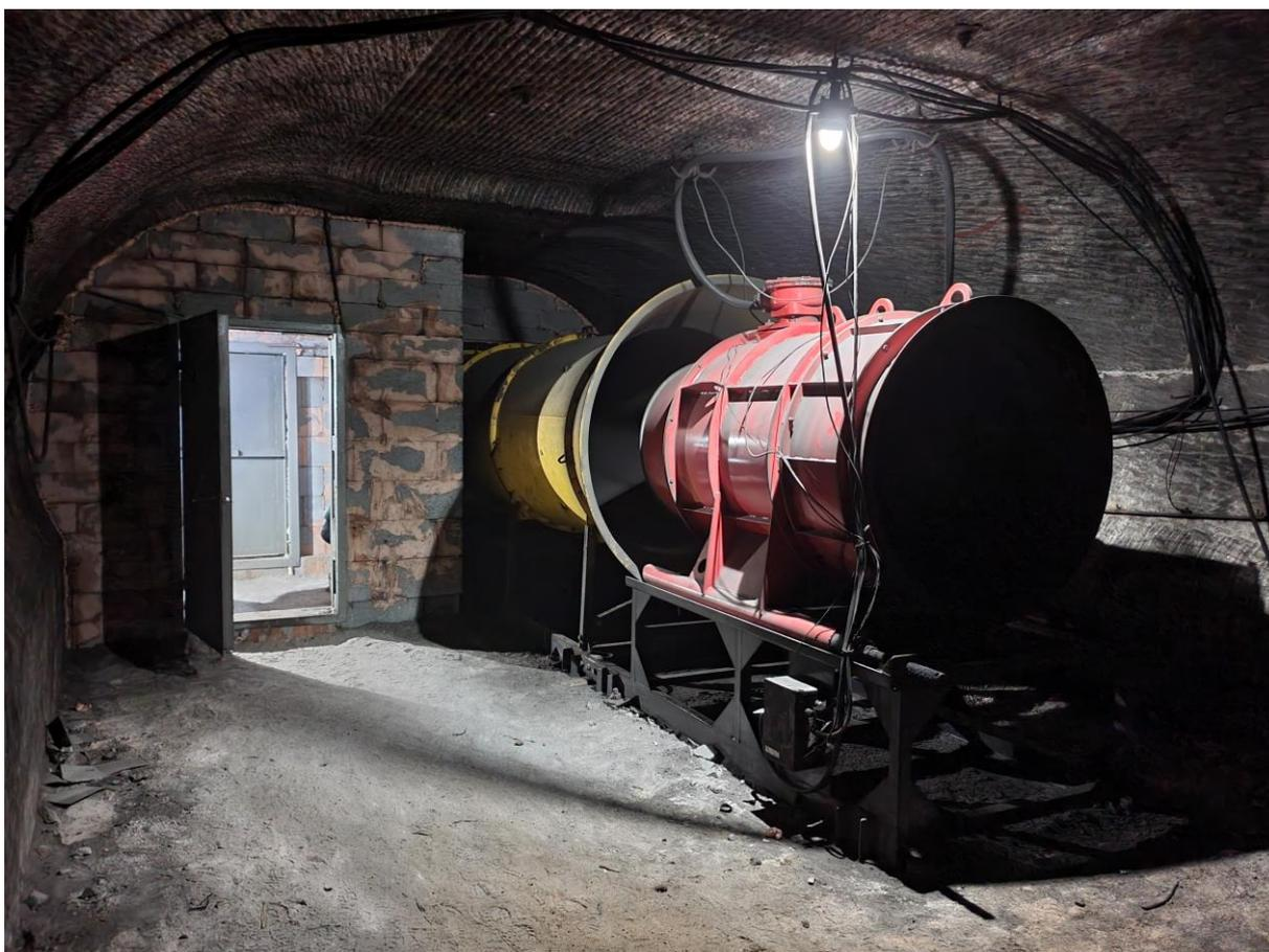
Рисунок 5.15 — Рециркуляционная система ПАО «Уралкалий»
