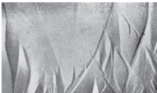
Рисунок 1.14 – Полосы деформации на детали из сплава Al-Cu, появившиеся после операции формирования [53].
