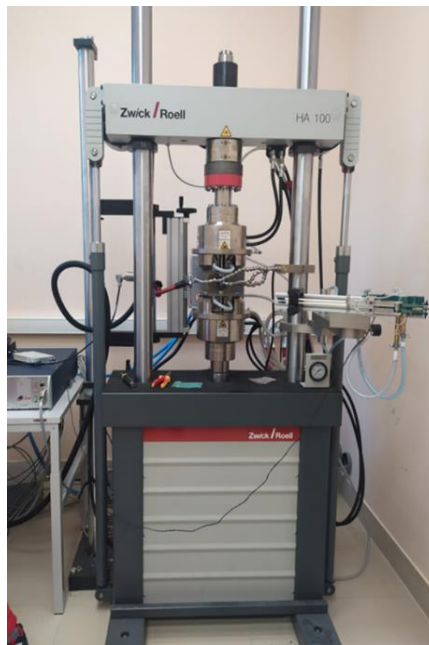
Рис. 2.1.3. Испытательная установка Zwick/Roell HA 100 с системой управления Zwick CUBAS
