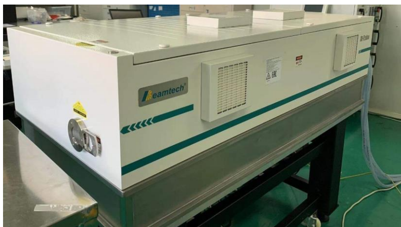
Рисунок 2.1 – Твердотельный лазер Beamtech SGR-Extra-10
