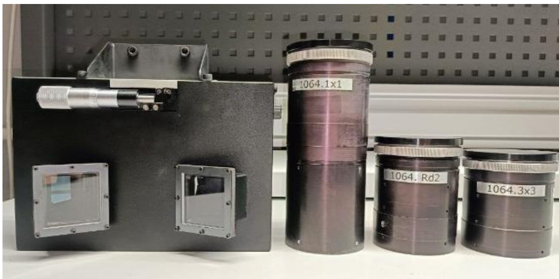
Рисунок 2.4 – Набор объективов для Nd:YAG лазера Beamtech SGR-Extra-10
