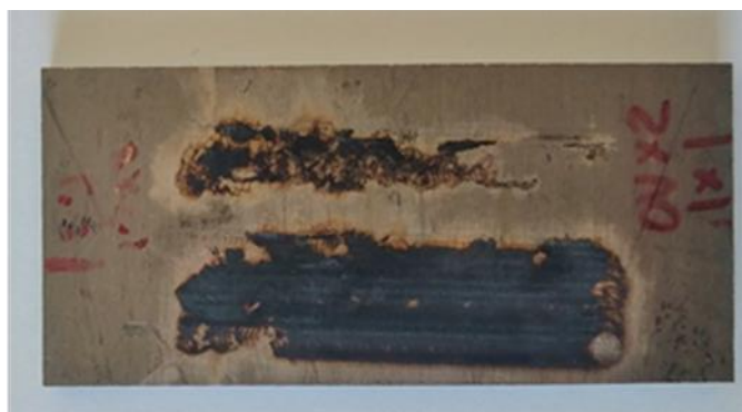
Рисунок 1.33 – Поверхность образца после ЛУО без поглощающего слоя
