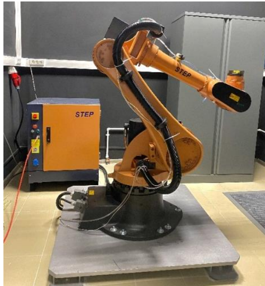
Рисунок 2.5 – Роботизированный манипулятор STEP SR50
