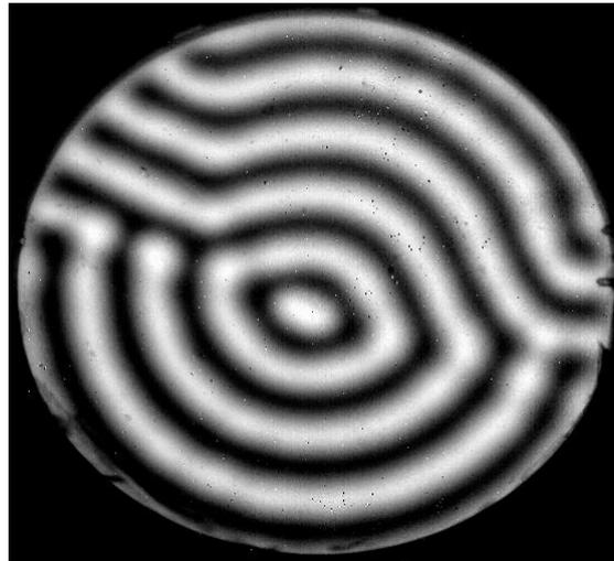
*Рис. 4* Пример термограммы с поверхности жидкости, находящейся внутри рабочей полости. Точки на изображении термограммы с наибольшей (наименьшей) яркостью имеют наибольшую (наименьшую) температуру
