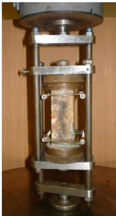
Рисунок 1.15 – Испытательное реверсивное устройство с подготовленным образцом
