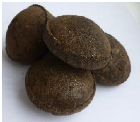
Рисунок 5 – Сравнительное испытание образцов пылей на когезионную прочность с различными пылесвязующими методом брикетирования:
