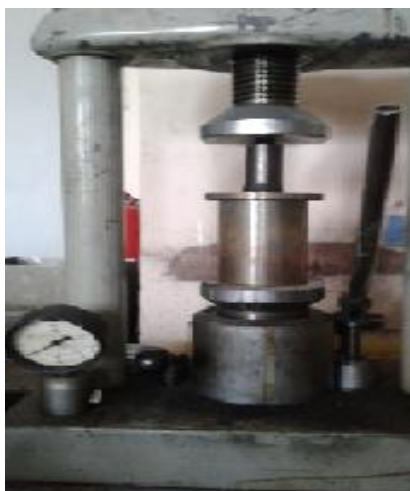
Рисунок 3.1 – Формовочный пресс ОЗ ВУХИН, УДНИИ (а), полученные брикетированные образцы пылей со связующим (б)
