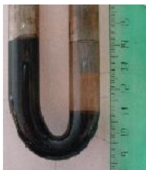
Рисунок 2.14 – Рабочий орган установки для определения электрокинетического потенциала эмульсии методом электрофореза:
