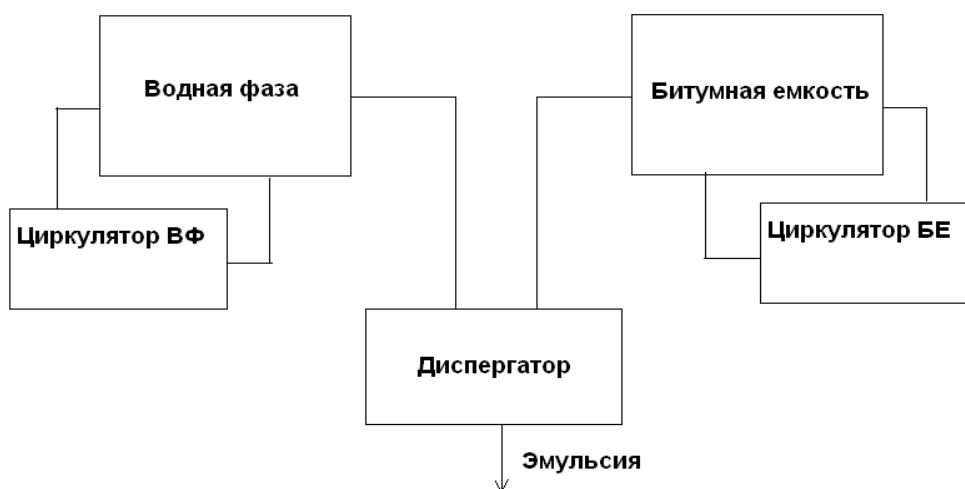
Рисунок 2.10 – Принципиальная технологическая схема битумно-эмульсионной установки
