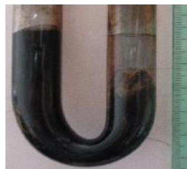
Рисунок 2.14 – Рабочий орган установки для определения электрокинетического потенциала эмульсии методом электрофореза:
