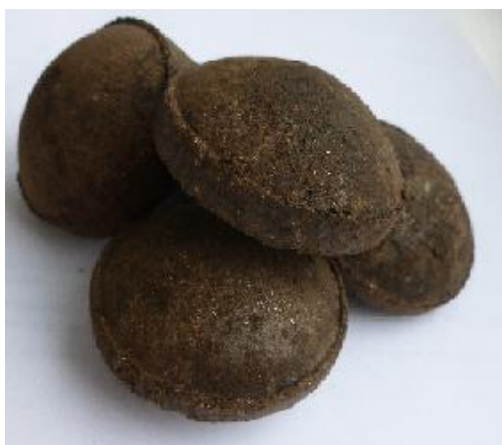
Рисунок 3.4 – Полусферические образцы для испытания на одноосное сжатие
