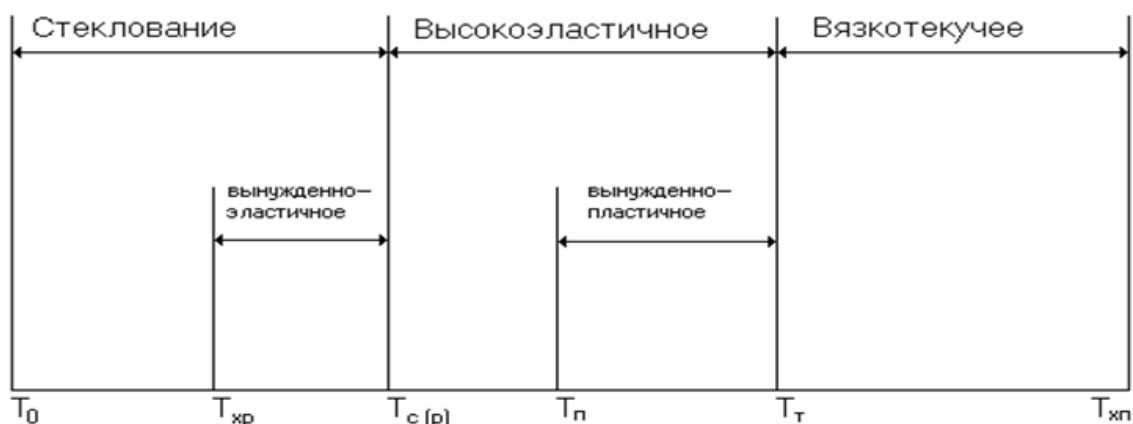
Рисунок 2.3 – Фазовые состояния битумного связующего при обратимом физическом стекловании в зависимости от температуры:
