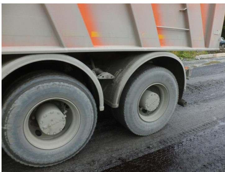
Рисунок 4.9 – Установленный факт отсутствия загрязнения шинной резины автотранспорта от профилактической эмульсии и эмульсионно-минеральной смеси, нанесенной на поверхность карьерной дороги
