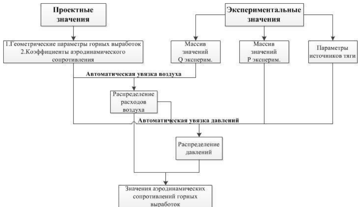
Рисунок 2.3 — Схема работы алгоритма автоматизированной обработки данных воздушно-депресссионной съемки
